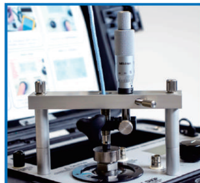
趋近式传感器校准可选项 9100-PPA01夹具用于校验电 涡流探头的静态和动态输出。
