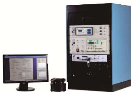
型号9155自动加速度计校准工作站， 如图包含 -100, -443, -445, -478, -830
